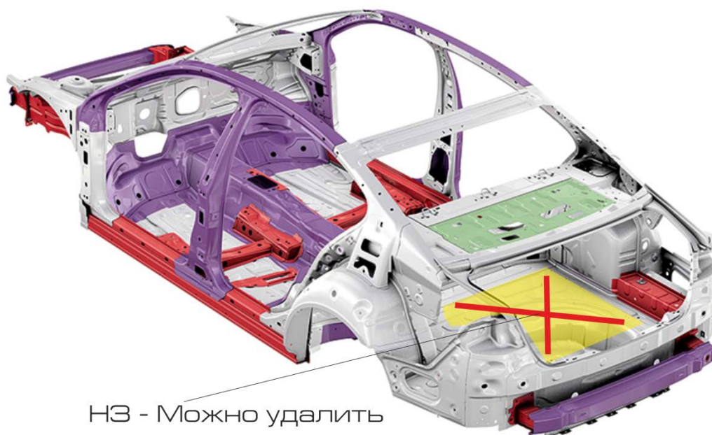
Рис. 8.4. Общая схема силовой структуры кузова.
